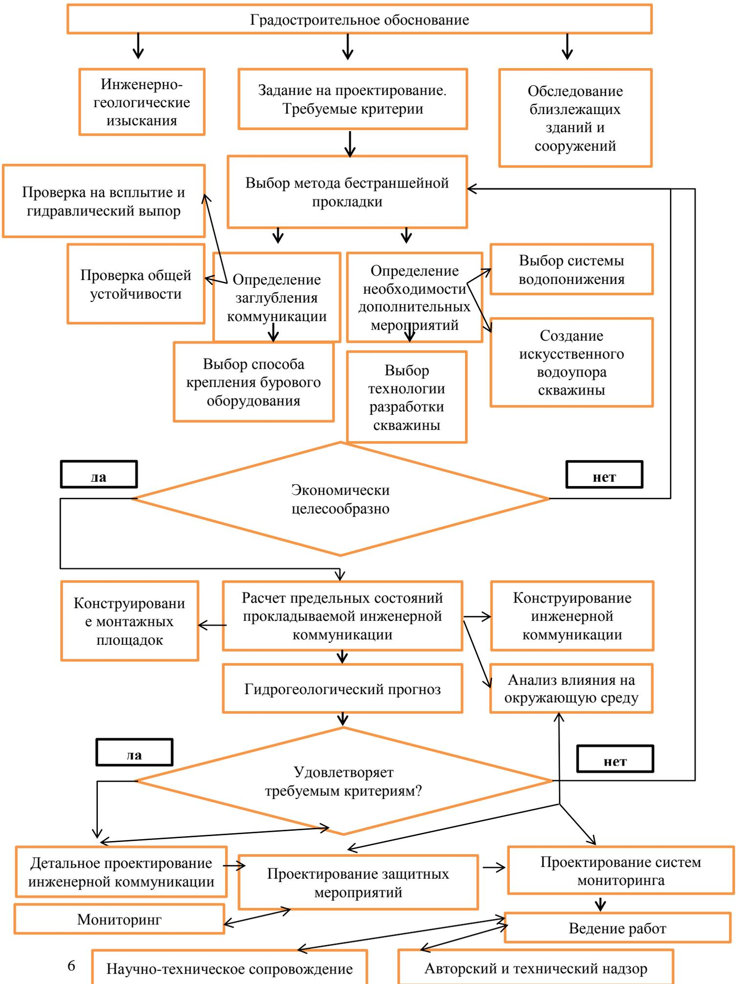
Рисунок 1 – Алгоритм процесса проектирования подземных инженерных коммуникаций с применением бестраншейных технологий
